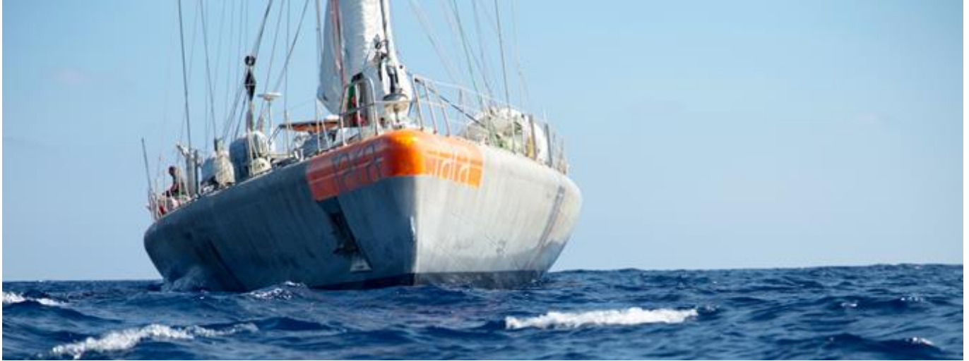
Рисунок 5. Судно «Тара» на открытой воде. Видна специфическая, яйцевидная форма корпуса судна.
