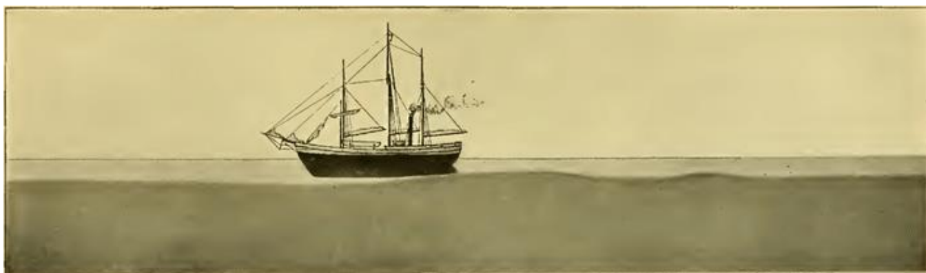
Рисунок 10. Фотография прозрачного ящика Экмана для изучения явления «мертвой воды».
