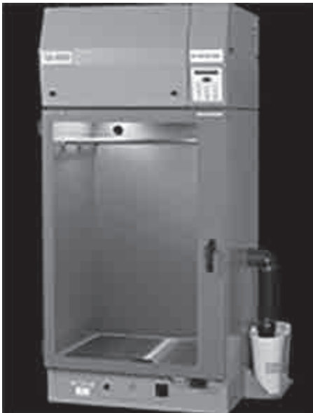
Рис. 2. Цианакрилатовая камера СА-6000.
