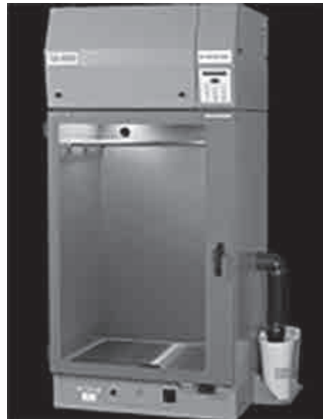
Рис. 3. Портативна окуривающая камера замкнутого типа.
